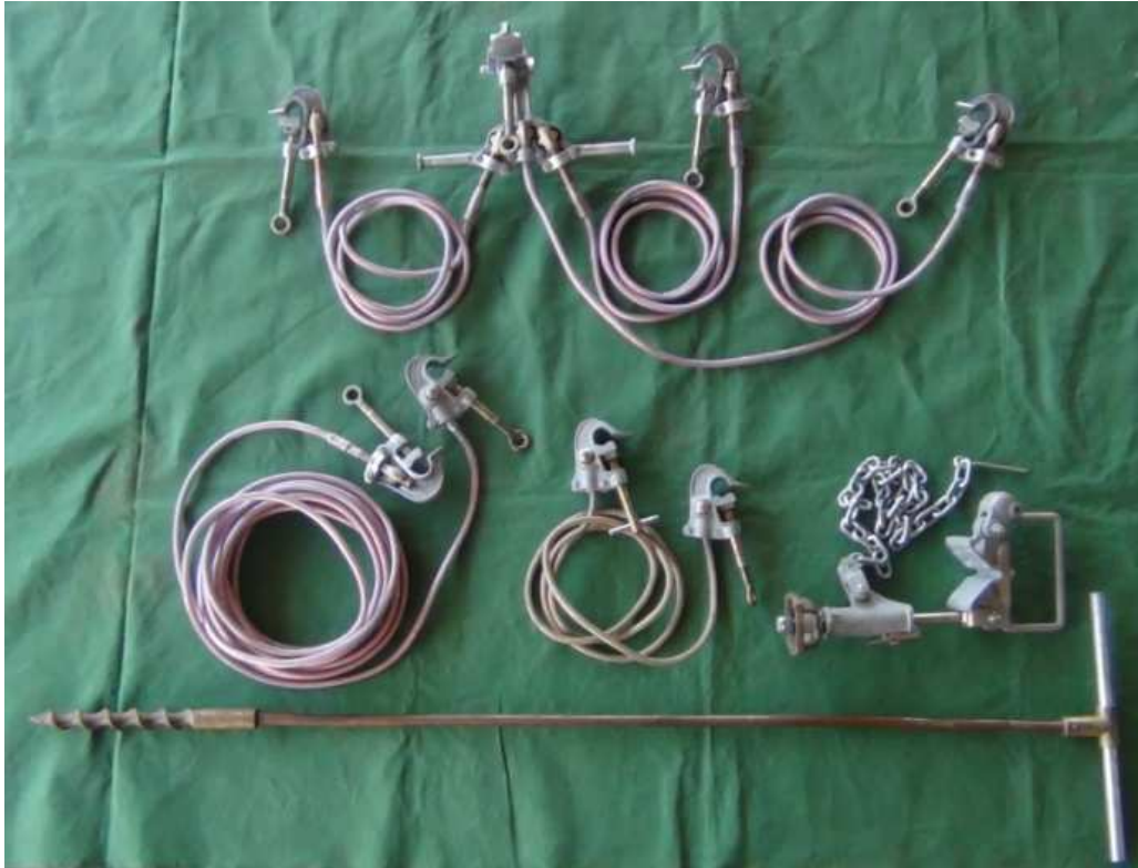
Foto 3 – Conjunto de Aterramento Temporário com Sela Trapézio para Circuitos de MT
