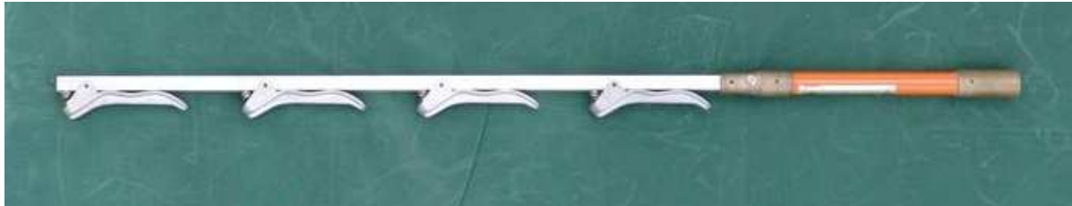
Foto 1 – Conjunto de Aterramento Temporário Tipo Bastão para Circuitos de BT
